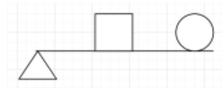
方距離支點比較遠，重物距離支點比較近
